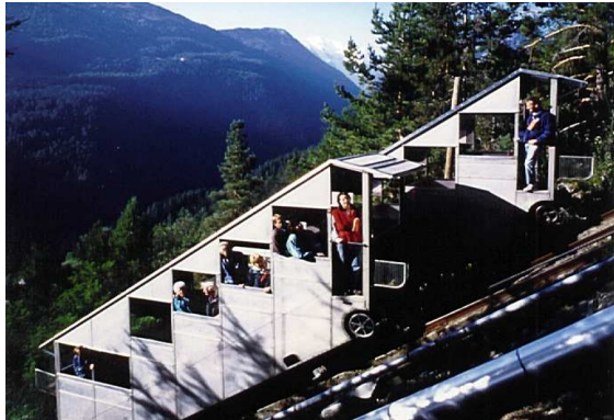
Steilste Funiculaire met 2 cabines ter wereld (87%).
