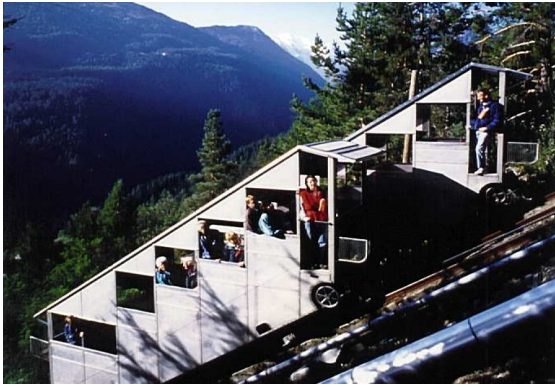
Historische Standseilbahn von Le Châtelard VS (1920) in der maximalen Steigung bei Kreuzung (87%).
